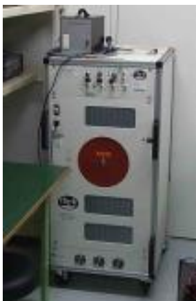
図9-7. 高電圧電源装置
