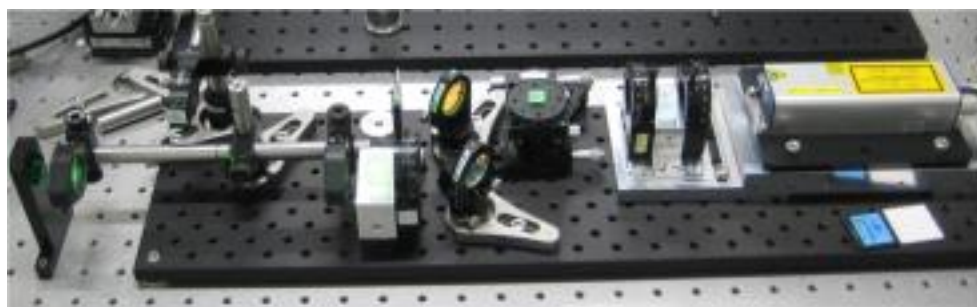
図9-14. ブレッドボード（600x150 mm）上に構築した第二高調波発生部
