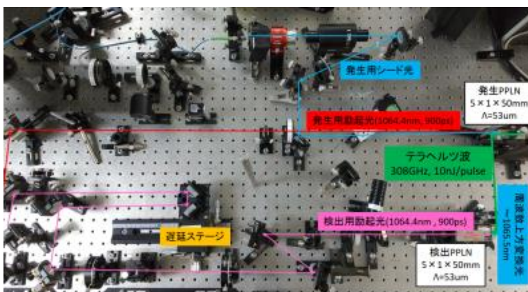
図5-4. 周波数アップコンバージョン検出の検証実験光学系。
