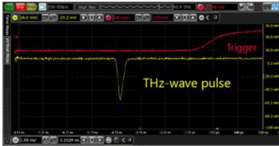
図2-22. 励起光源一体型BW-TPOモジュールから得られたTHz波パルス信号。
