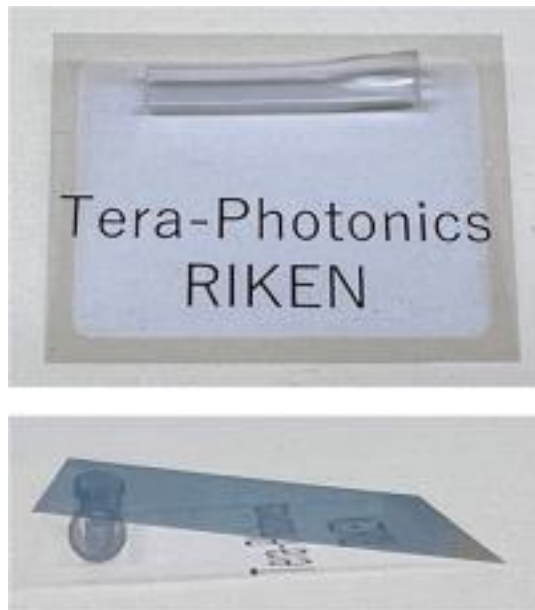
図2-19. 開発したダイクロイックミラー（近赤外光とテラヘルツ波を分離する光学素子）の写真（特願2022-021012）。
