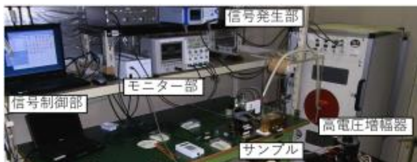
図8-3. 結晶作製装置一式とその信号波形
