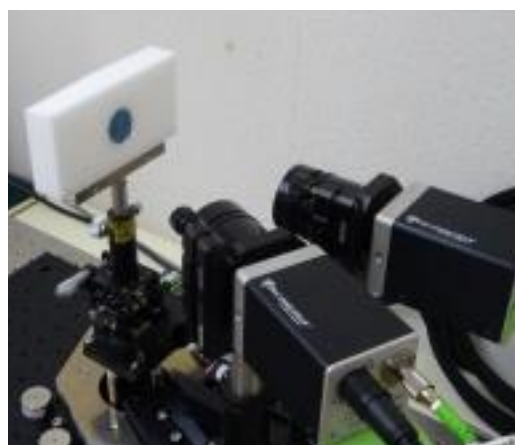
図7-31. 金属マイクロコイル吸収体の反射・散乱特性の角度依存性の実験セットアップ。
