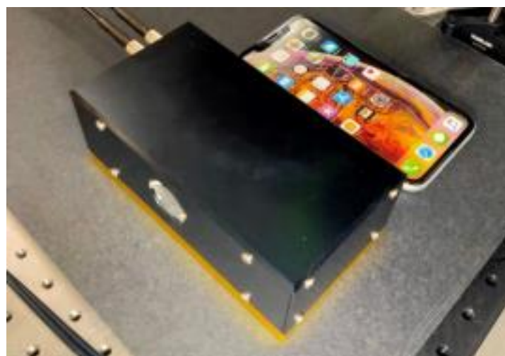
図2-20. 開発した励起光一体型バックワード・テラヘルツ波パラメトリック発振器の写真。
