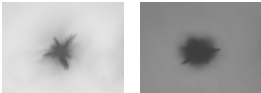
図9-16. 自動照射シーケンスで撮像した結晶のレーザー損傷状態 サファイア（左） 水晶（右）
