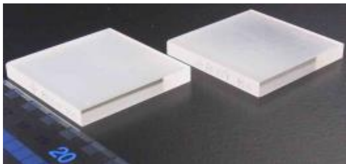
図9-9. 完成した40 mm角PPLN素子（外形40 mm角、厚み5 mm、周期35 \mu\text{m} ）
