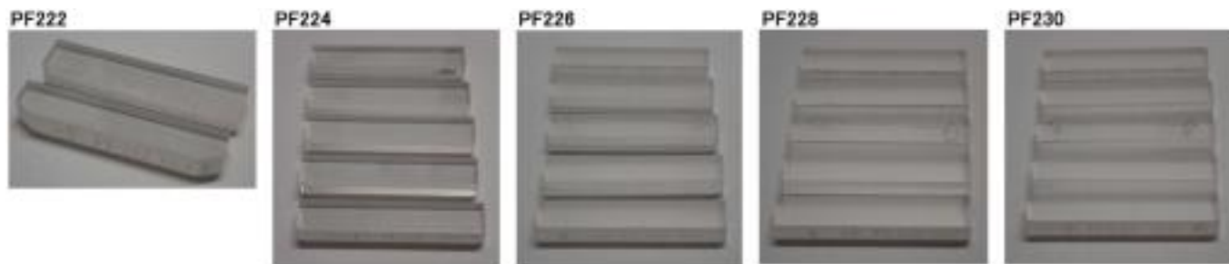
図8-10. 切断加工後の棒状PPLN素子
