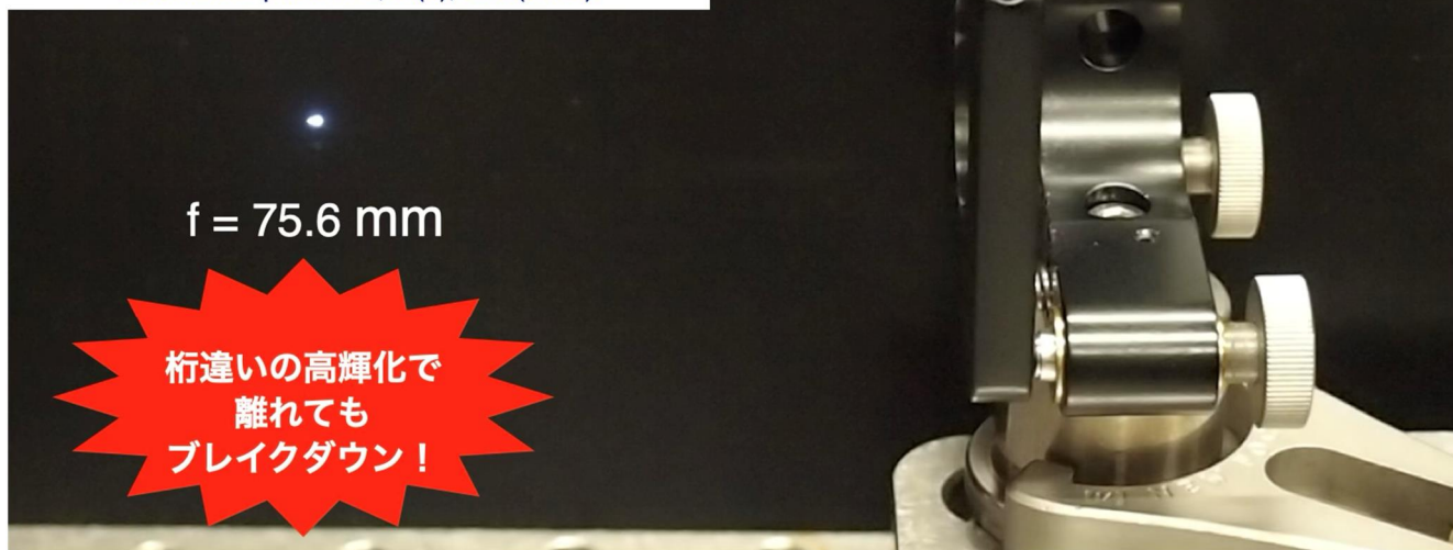
図 4.1.3 PowerChipによるブレイクダウンの外観 (2008年のNature Photonicsに掲載当時と比べ10倍以上長い距離でも安定なブレイクダウン)
