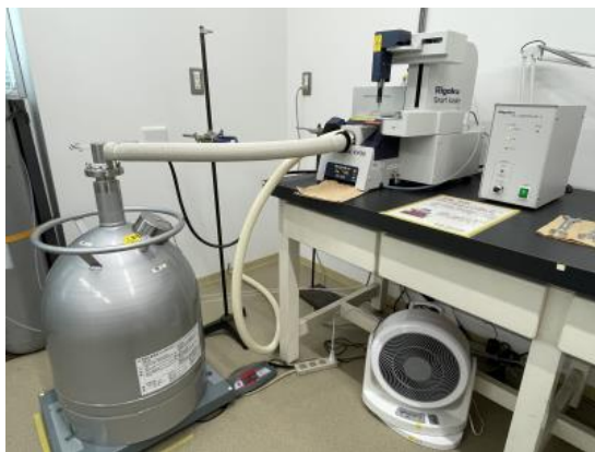
図3.12.2 YAG結晶、YSAGおよびYAGセラミックスの比熱（右）および計測装置（左）
