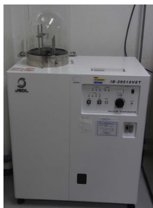
図3.6.1 真空蒸着装置
