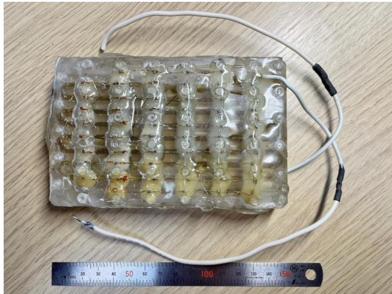
図3 製作したEHDポンプの例を示す。
