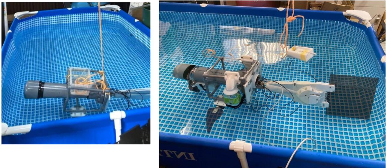
図 1 9 ヒレ推進魚ロボット水平姿勢調査の様子
