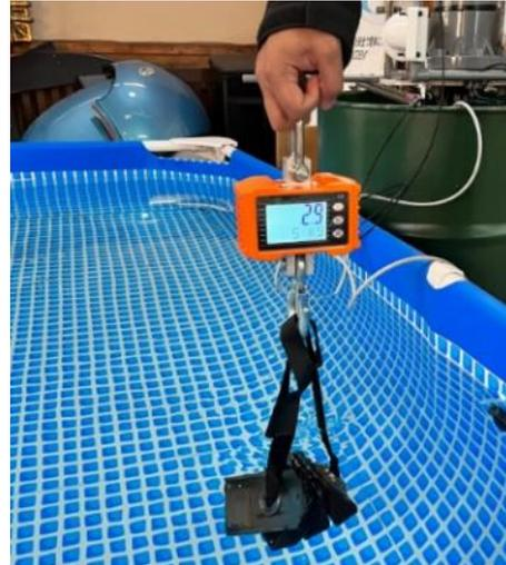
図 2 0 サドルバンドに搭載した追加の金属重り
