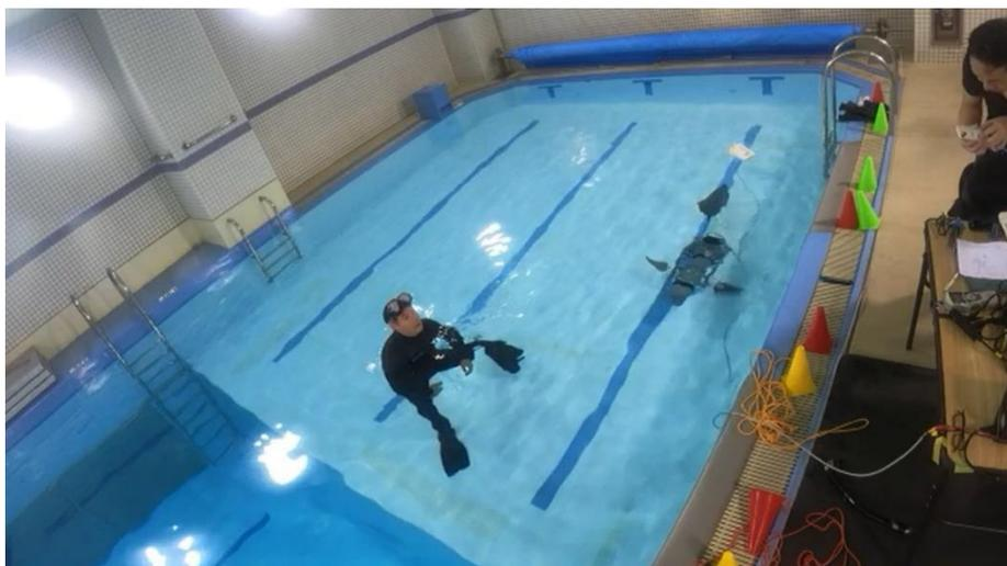
図 2 1 ヒレ推進魚ロボット試作機の試験の様子
