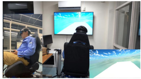
図1 HMDシミュレータのプロトタイプ（左：規則波中、右、実海域不規則波中） （動作性能確保（実船スケールでの遅延1s以内）の目標を達成）
