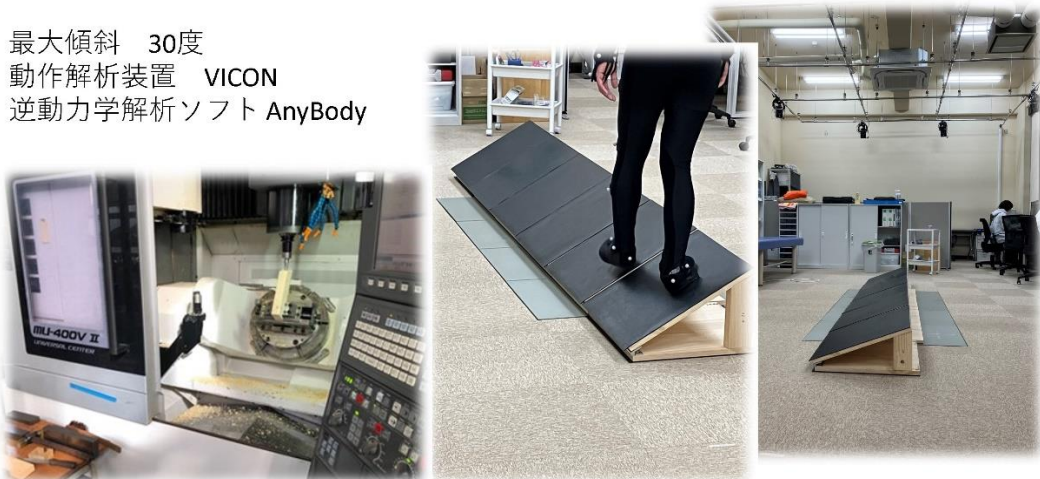
図 10. 動作計測環境下での不整地歩行のための角度調整機能付き傾斜板
