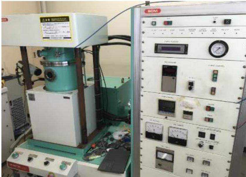
図 2-7 SPS 焼結装置（東工大）
