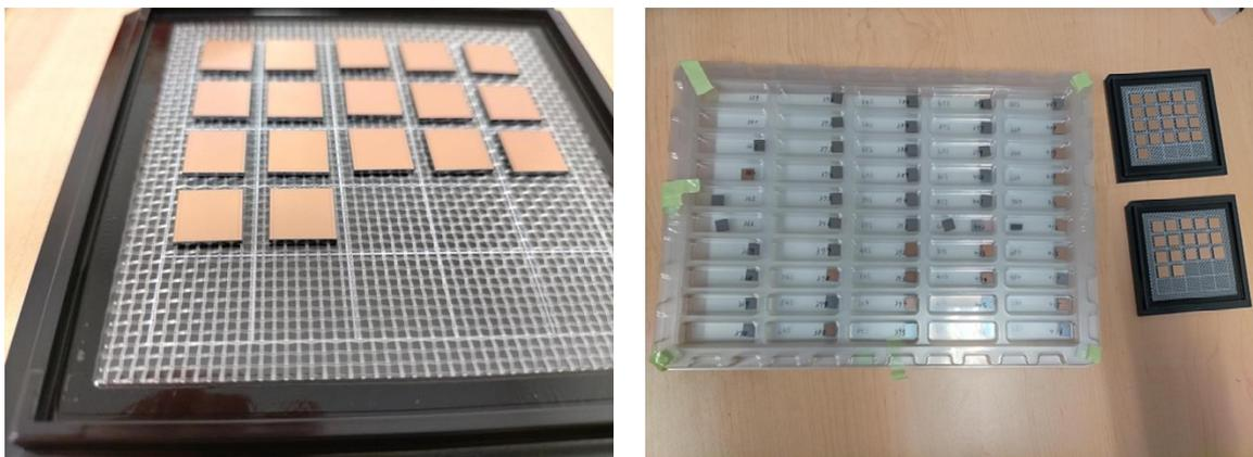
図3(2)5-1: 試作したセンサモジュール
