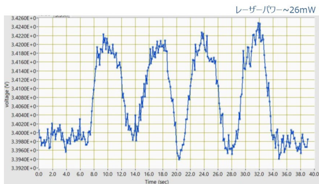
図 37 小型センサヘッドを用いた磁場計測結果。 ヘッド側から電磁石により \pm 2.5mT の磁場を印加している。
