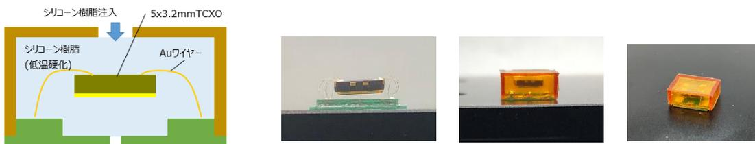
図(2).6 シリコン樹脂埋めによる試作品 1
