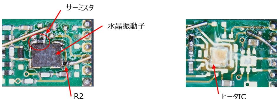
サーミスタを水晶振動子に近接配置した基板外観
