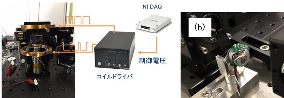
図(5)-2-②.7 パルス変調システム：(a)四重極磁場 (b)トラップ光リポンプ光
