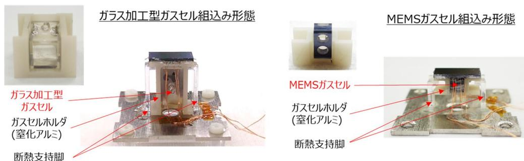
図(3)-1.9 実験室モデル量子部 2 次試作のガスセル支持部外観
