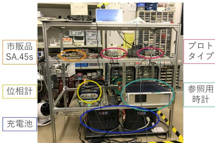
図(5)-1-③-1.6 車載実験に用いた積載装置一式
