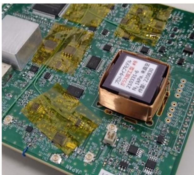
図(1)-2-①.3 石英製ガスセルが実装された真空断熱型量子部とその制御基板
