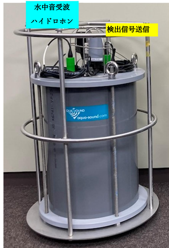
図 3-2-4-9 令和 5 年度版のサウンドスケープ録音機
