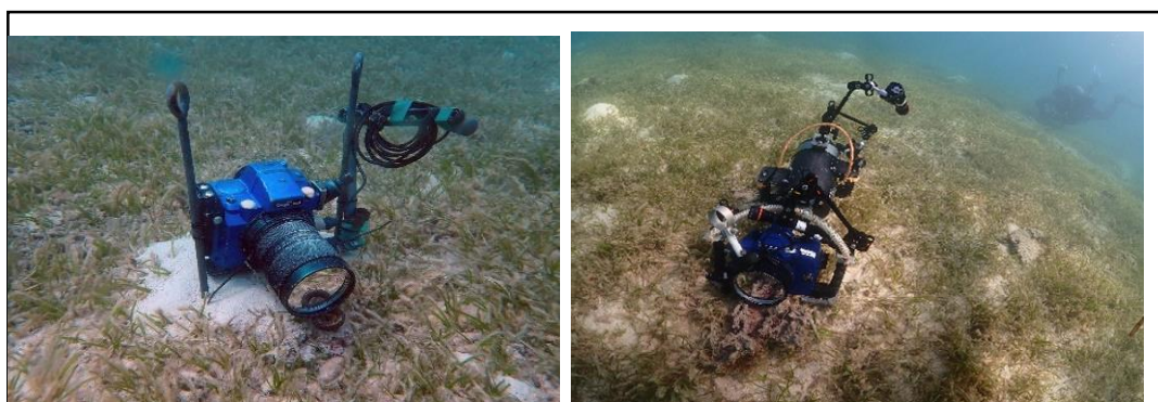
図 3-1-5-3 海底設置状況（27-30 時間収録タイプ）
