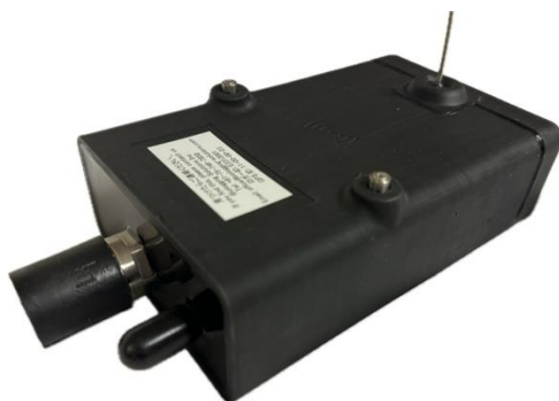
図 3-2-7-20 開発した衛星通信機能一体型ロガー
