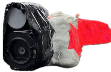
図3-2-7-8 アオウミガメ用に試作したカメラロガー（浮力体有）
