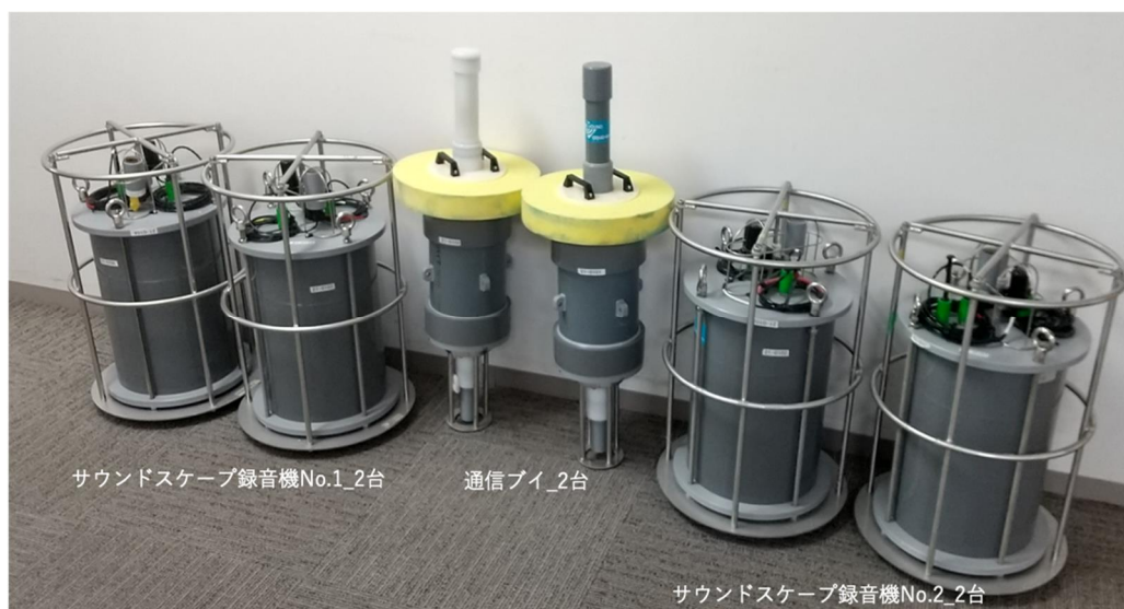
図3-2-4-6 2式のサウンドスケープ録音機と通信ブイ
