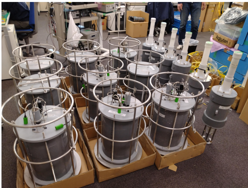
図 3-2-4-11 令和 5 年度に製作したサウンドスケープ録音機と通信ブイ
