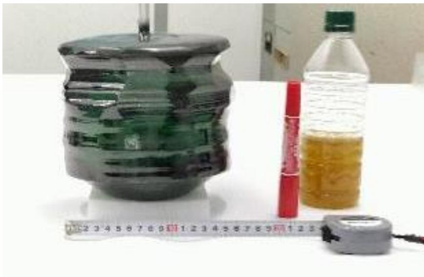
図 6a-21  $\phi 225 \times 300 \text{ L}$  Mo ルツボを使用して育成した最大径  $\phi 177$  mm、全長 172 mm の Yb:YAG 結晶
