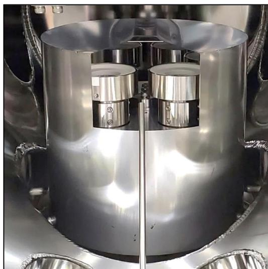
図 4a-14 ターゲット収納数を拡張したターゲット機構。
