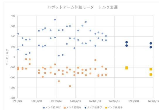
図 3c-11 ロボットアーム伸縮モータのトルク
