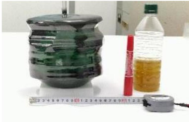
図 4 - 4 本プロジェクトで提案した TSMG 法によって育成した有効径 160mm を超える有効径を持った Yb:YAG 単結晶。
