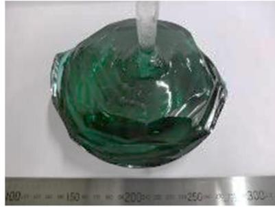
図6a-16 TSMG で育成された Yb 5 at % ドープ YAG 結晶 ( as-grown ) 。
