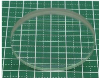
図7a-6 Φ 50 Nd:YAG/YAG 接合体。両面ARコート済み。
