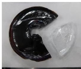
図 6a-9 一部大気熱処理した YAG 結晶。
