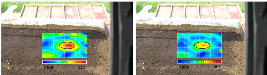
図 3.2.4.20 振動エネルギー比分布：100-140 Hz、埋設深度 50 mm
