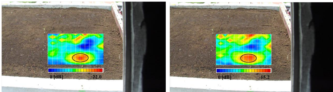
図 3.2.4.22 振動エネルギー比分布：100-140 Hz、埋設深度 100 mm
