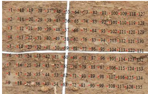
図 3.2.3.5 スキャンエリア図 (9×15=135 points)
