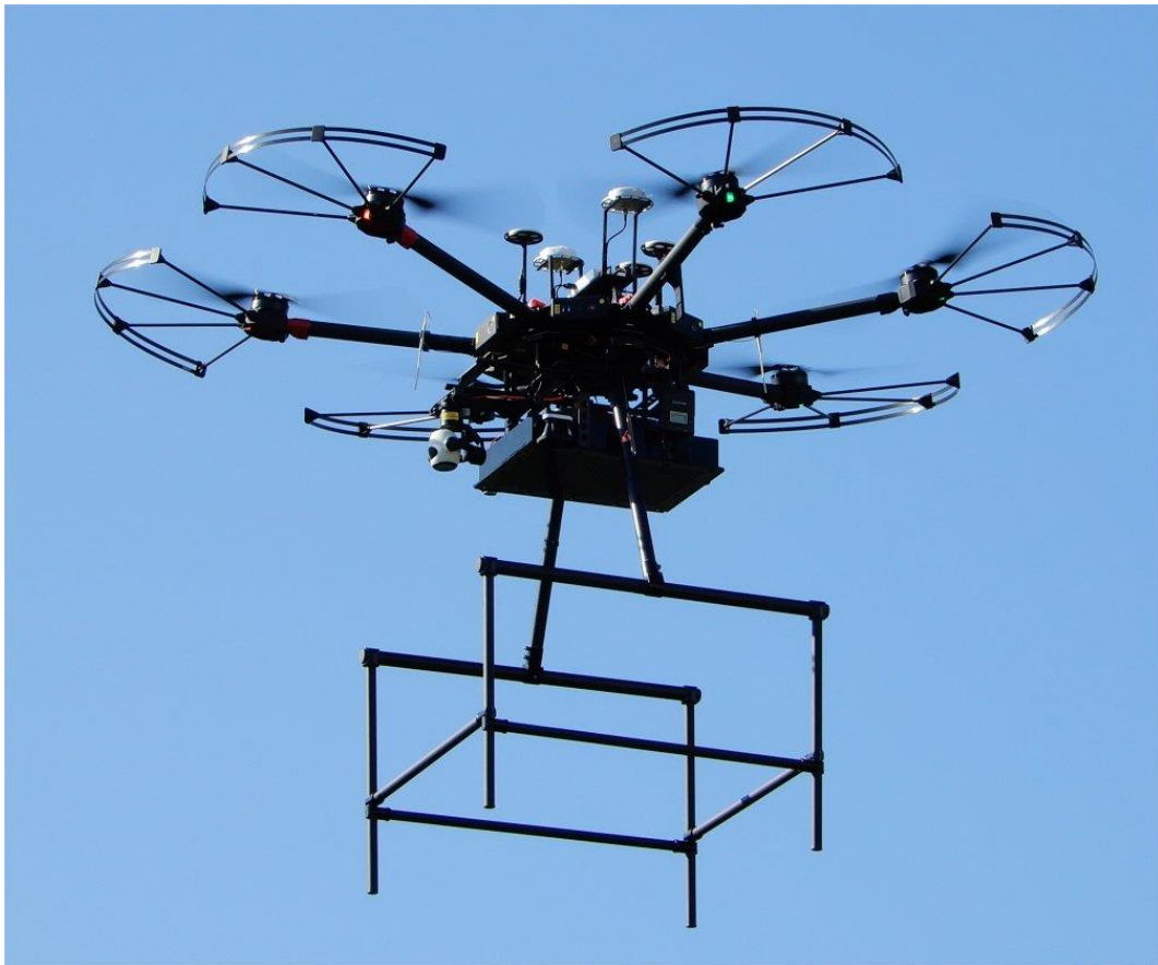
図 3.4.1.1 地中探査用に試作された音源搭載型 UAV の写真(2019 年 12 月 16 日)
