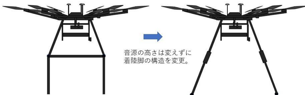
図 3.4.2.3 音源搭載型 UAV の着陸脚の構造の変更
