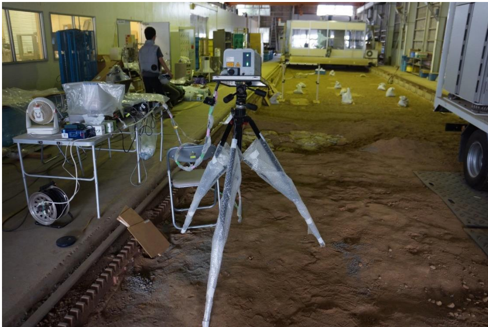
(実験時参考写真 A : 遠距離計測時 (離隔 10 m) 時の機材配置例、2019 年 8 月 6 日)
