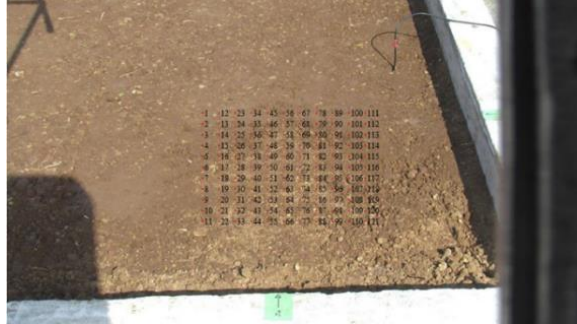
図 3.5.1.5 スキャンエリア図 (11×11=121points)
