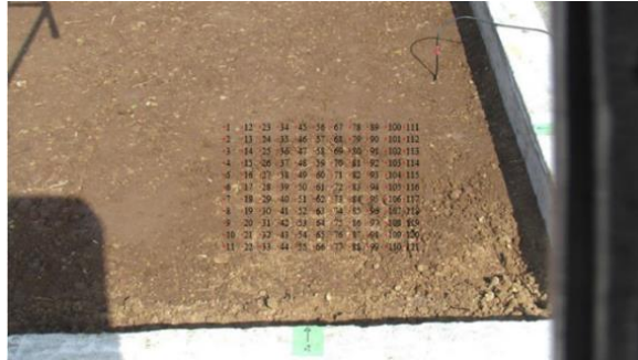
図 3.5.1.5 スキャンエリア図 (11×11=121points)
