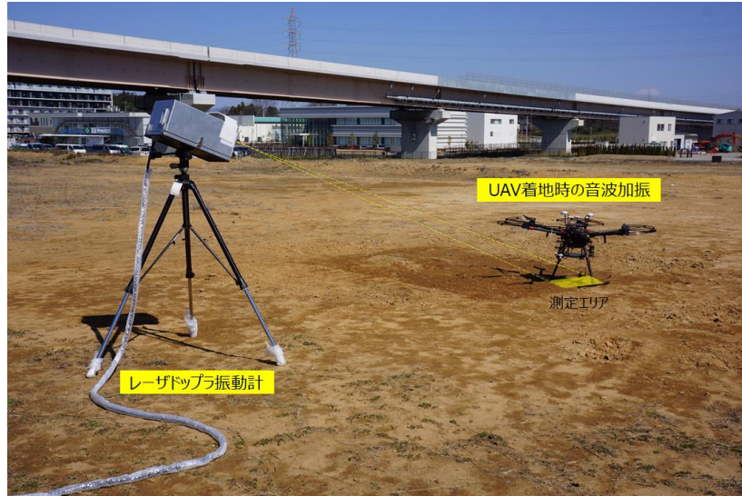
図 D-1 UAV 着陸状態での計測セットアップ例
