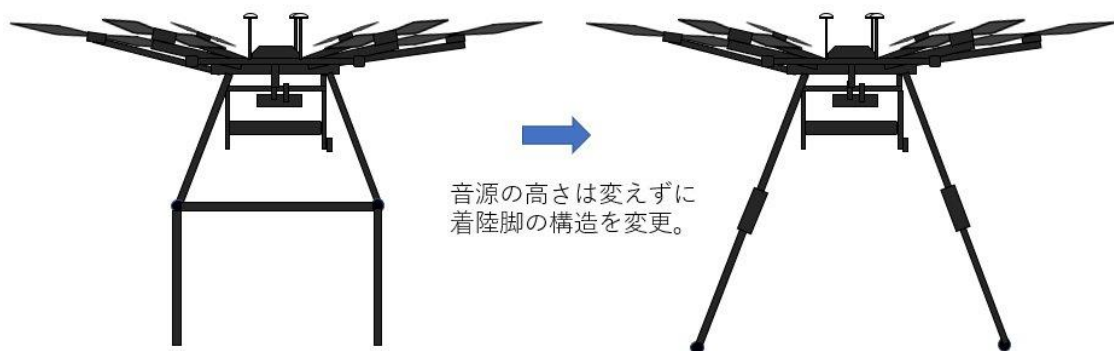
図 3.4.2.8 音源搭載型 UAV の着陸脚の構造の変更
