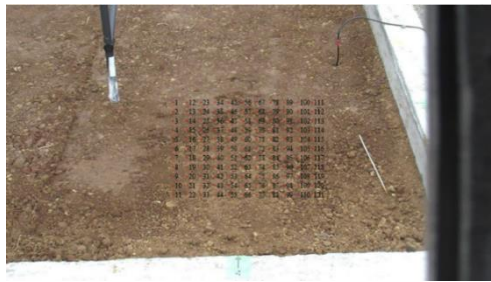
図 3.5.1.11 スキャンエリア図 (11×11=121points)
