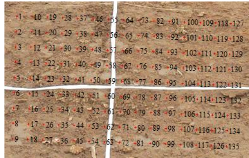
図 3.2.3.5 スキャンエリア図 (9×15=135 points)
