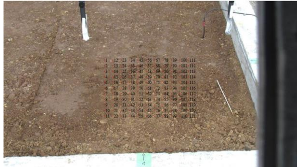
図 3.5.1.8 スキャンエリア図 (11×11=121points)
