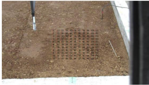
図 3.5.1.11 スキャンエリア図 (11×11=121points)
