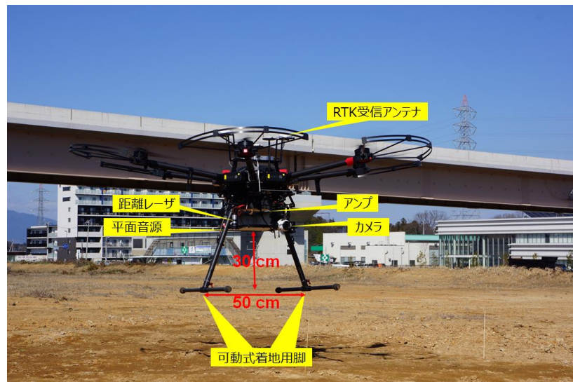
図 D-2 UAV の着陸脚と音源の位置関係
