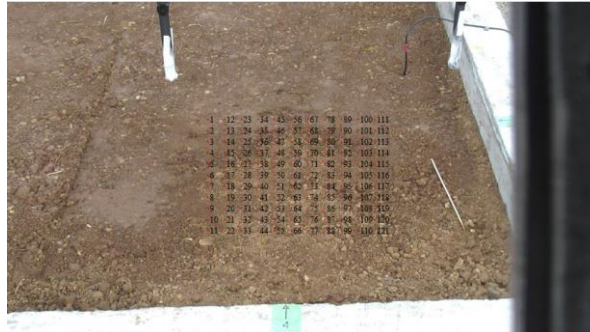
図 3.5.1.8 スキャンエリア図 (11×11=121points)
