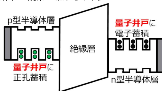
図①-8. 積層型量子井戸構造デバイスにおける充電時のモデル
