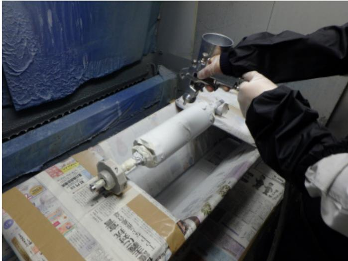
図 3-4 エアースプレーによる円筒ドラムへの塗装
