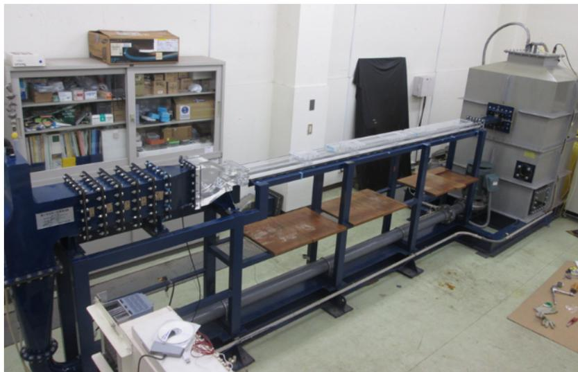
図 6-3 小型回流水槽へのせん断力計測チャネル設置状況
