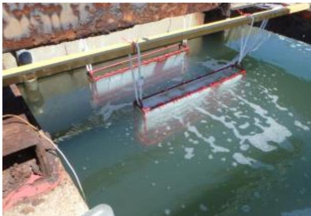
図 5-2-7 試験枠の設置（表面側）
