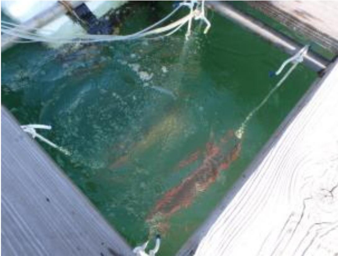
図 5-2-1 7 防汚性試験の様子（手前がバブル無、奥がバブル有）
