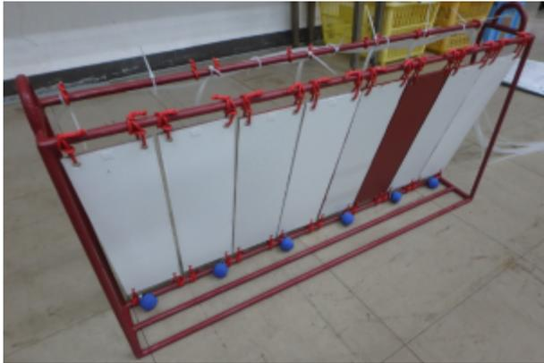
図 5-2-2 試験板の試験板への取り付け（表面）
