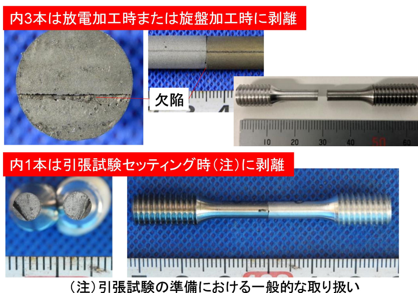
図 1.1①-5-2 予熱温度約 250°Cで造形し引張試験前に破断した Al on Ti 試験片
