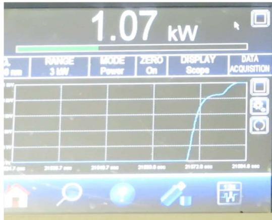
図 2.3.1.4.2-3 1070W 出力時のパワーメータ表示写真
