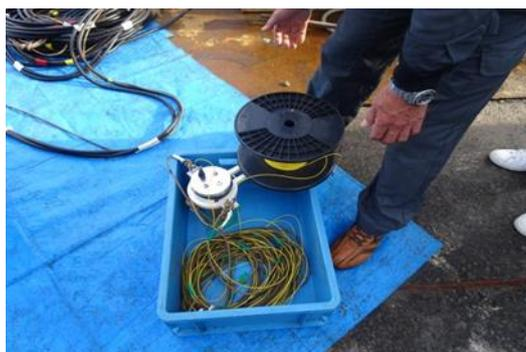
図 53 耐圧容器と光ファイバケーブル
