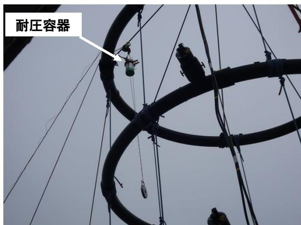
図 58 耐圧容器位置 S：コイル内側近傍
