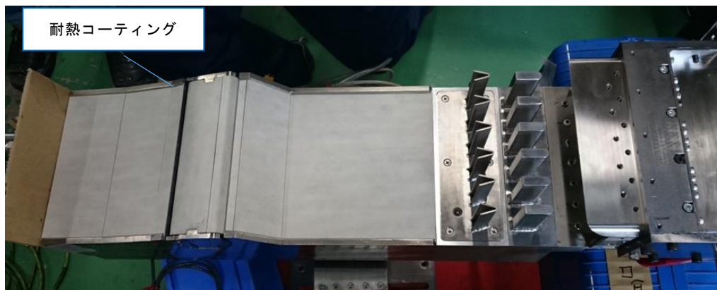
図 2.2-8 可変ノズル 耐熱・冷却構造組立状況 C/C 部品に対し、耐熱コーティングを実施 Si/APS (75 \mu m) + YSZ/APS (200 \mu m)
