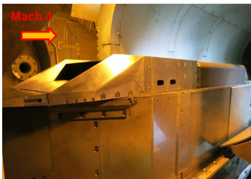
図 2.7-3 ラムジェットエンジン試験設備への実証用小型ラムジェット設置状況
