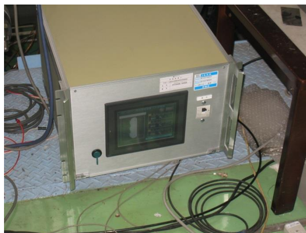
図 2.4-4 燃料タンク加熱器 制御装置
