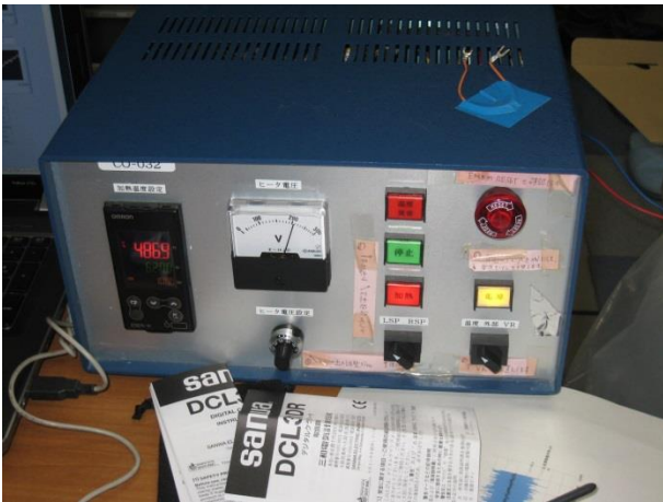
a) 加熱器制御装置
