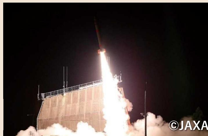
令和4年7月24日、極超音速飛行中の空気吸い込みエンジン(スクラムジェットエンジン)における燃焼装置のデータ等を取得するため、観測口ケットによる飛行試験を実施した。取得したデータ等は、地上での風洞試験結果を補正して実飛行状態における特性を予測する解析ツールの評価に用いる。
