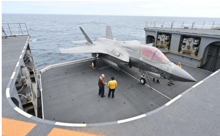
昇降機を用いた甲板への移動
