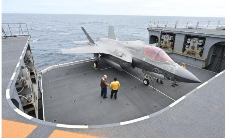
昇降機を用いた甲板への移動
