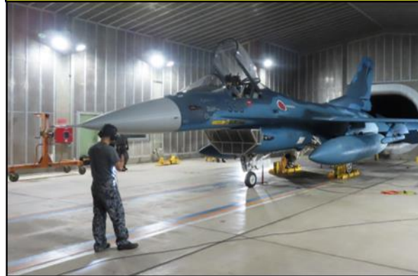
エンジン出力及び 出力信号の点検
