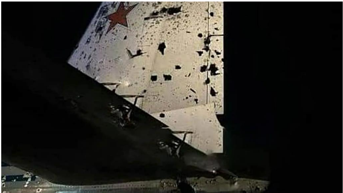
図 5. 撃墜された A-50 と共に被弾し不時着した IL-22 の破損状態（尾翼） (出典: Colonel Yurii Ihnat, Ukraine's Airforce spokesman on Facebook)
