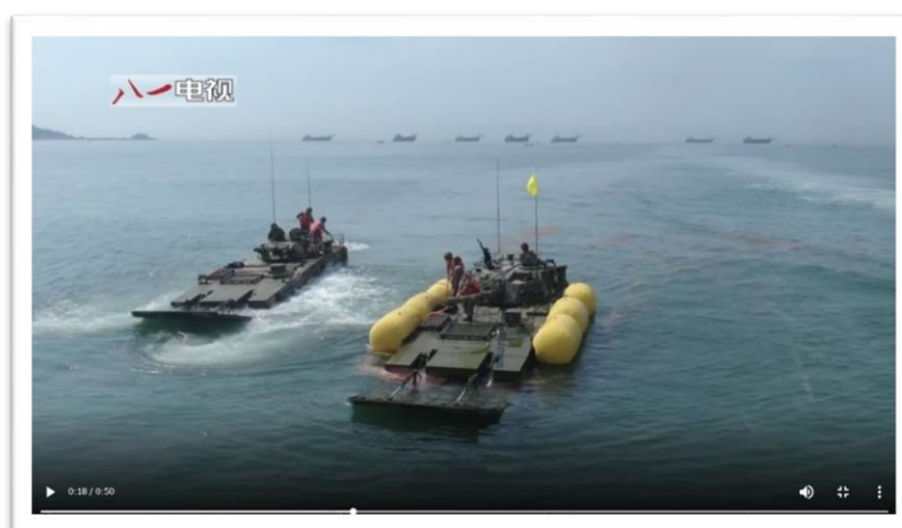
図9 航行不能となった水陸両用戦闘車（右）を救助牽引する訓練の様子
