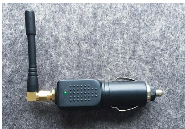
写真 3-1 市販されている GPS ジャミング装置
