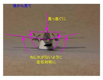
2. 軽く手で飛ばしてみて飛行機の飛び方によって尾翼を調整してください。
