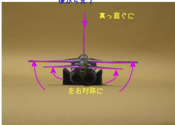
2. 軽く手で飛ばしてみて飛行機の飛び方によって尾翼を調整してください。
