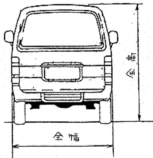
付図 1－給食運搬車 2号の形状
