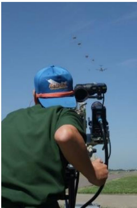
XC-2の物量投下試験における 光学計測（シネセオドライト）
