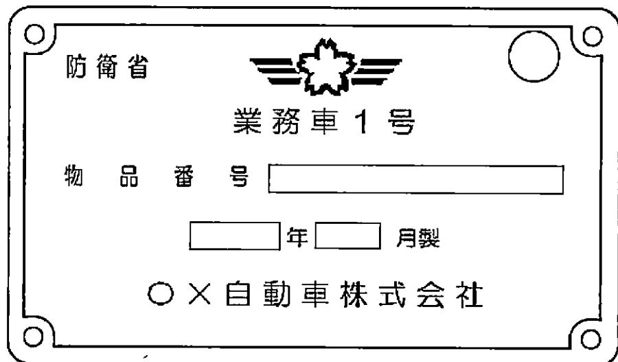
図2-1-1種銘板（契約の相手方と実際の製造業者が同一の場合）
