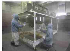
OD色を塗装中の水タンク
