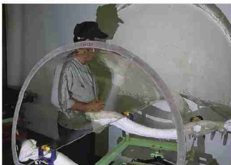
特殊な光を当て、スクリーンに投影された光学的な歪みとキズをひとつ残らず把握し、研磨を要する箇所にマークする。
