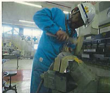
しぼり作業(アルミの曲線加工)中の正垣さん (写真:三菱重工業)
