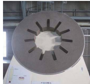
大型推進薬のカットモデル (H2A用)
