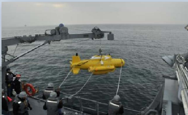
機雷処分具を投入する掃海艇
