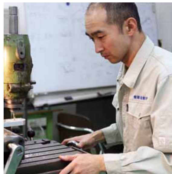
供試体保護のため治具を状況にあわせて加工
