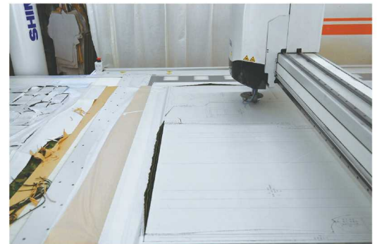
重ねられた生地と型紙の機械による裁断。
