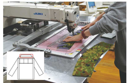
襟の部分のパーツ作成作業。 自動でW型の縫い付けができる。
