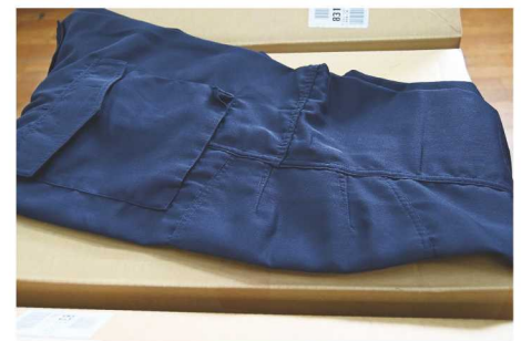
立体裁断による丸み。縫い付けが難しく、また、縫い付け箇所も多い。
