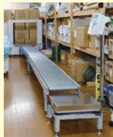
発送作業時の計量・梱包用機械 （ローラーの上を移動させることで楽に作業が可能）
