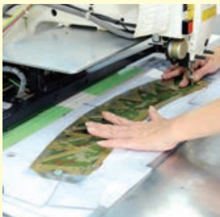
作業服の襟部分のステッチ縫製の状況 （「パターンホーム」 という治具を使用することで効率よく作業が可能）
