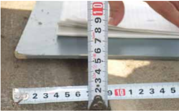
段差部の確認
