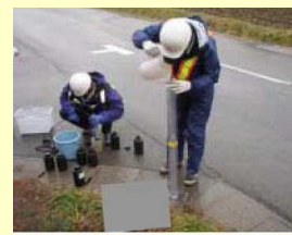
多項目水質計によるpH測定のイメージ 国交省国総研WEBより
