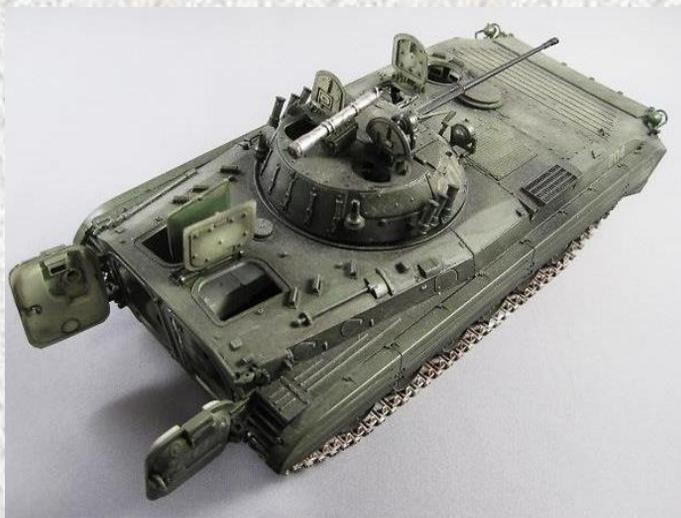
後部左のドアにはガンポートが、右扉はペリスコープのみとなっています。乗車したままの突撃時に制圧射撃する際に有効だとは思いますが、使用することあるのかな？あまりそのようなシーンを写真でも見かけないので。
