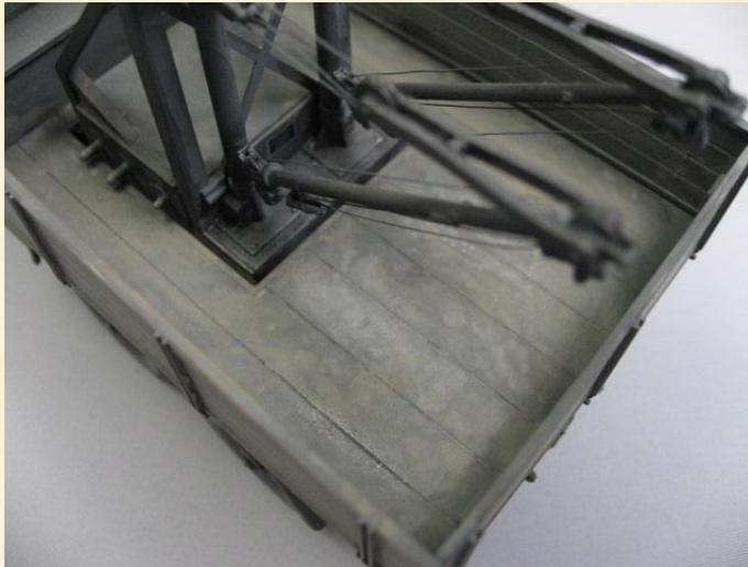
後部のクレーン部分のアップです。滑車をくぐらせて取り付け細いワイヤーは注意が必要でした。気を抜くとすぐに緩みます。かといってキツく取り付けるとクレーン本体が歪んでしまいます。程よいところで瞬間接着剤でワイヤーを固定しつつ作業を進めました。床に泥汚れのほか光沢のあるグレー色でオイル汚れを表現しています。写真では分からないかも。
