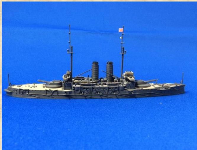
今まで作ったことのある洋上モデルは船体が一発成型だったのですが、シールズモデルのキットは船体が左右分割式で、そのためか船体側面のモールドがしっかりしている印象を受けます。もっとも最近のキットは立体一発成型ですのでモールドが素晴らしいですね。
