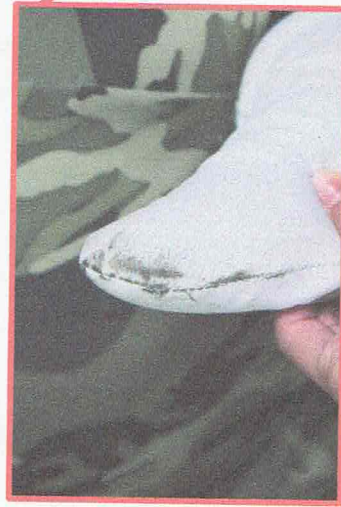
(右) こすれ破損
