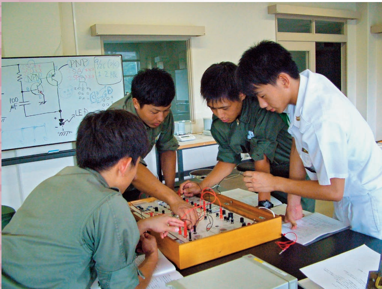
機能材料工学実験：金属および半導体の電気的測定。材料の電気的性質の根本となる概念や法則を実験を通して学びます。
