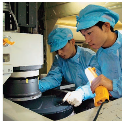
卒業研究（制御加工実験室）：大型基板用超精密研磨装置の開発を通して精密加工を学ぶ。
