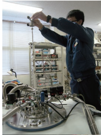
卒業研究（超伝導物性研究室）：低温装置を用いた超伝導実験。
