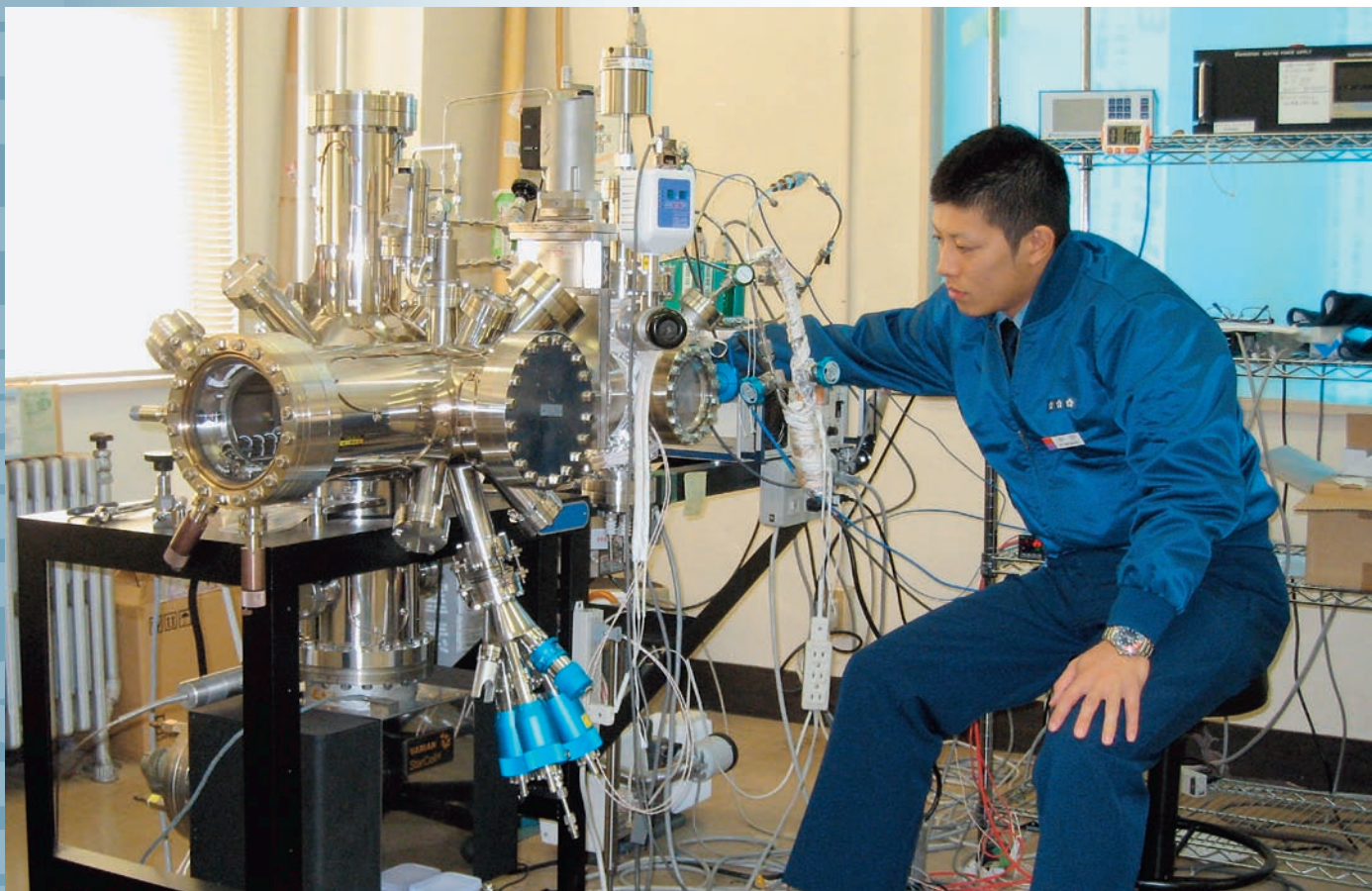
卒業研究（電気機器工学研究室）：半導体表面に原子レベルで極薄な酸化物膜を成長させる研究
