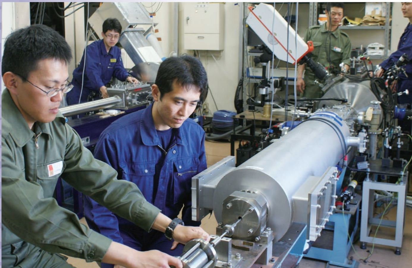
超高速衝突実験：小型2段階軽ガス加速装置を使って、微小隕石や宇宙デブリの衝突を模擬する実験を行う。
