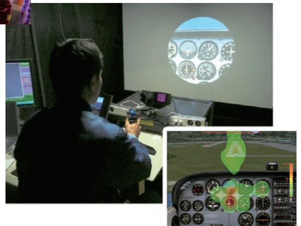
卒業研究（脳情報処理研究室）：航空機操縦時の視線計測と有効視野の解析。
