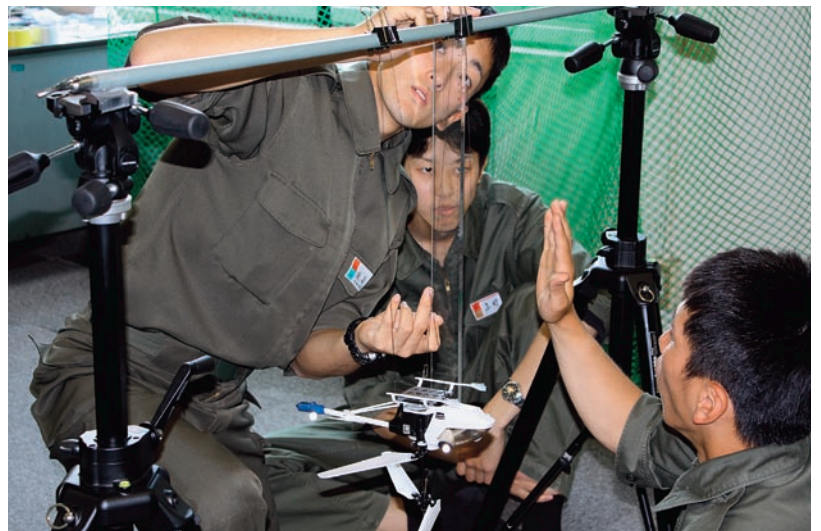
卒業研究（計測制御実験室）：RCヘリコプタの飛行制御実験のための模型諸元計測
