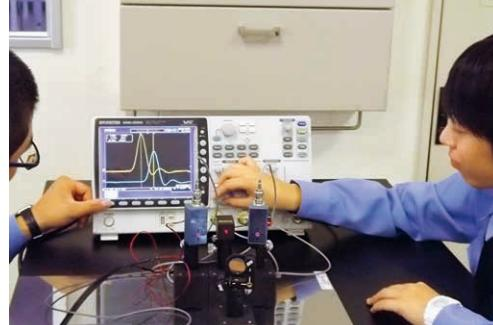
基礎科学実験（物理分野：光速の測定）
