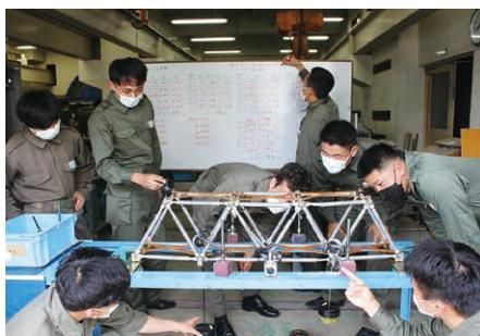
構造・コンクリート実験：橋梁模型に荷重を作用させ、変形量を理論値と比較・検証する。
