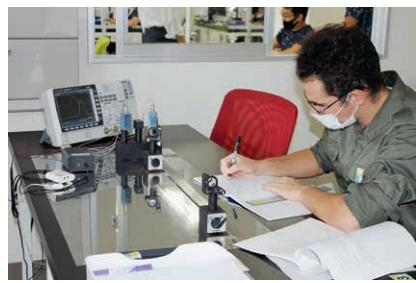
短パルス長周期レーザーによる光速度の測定
