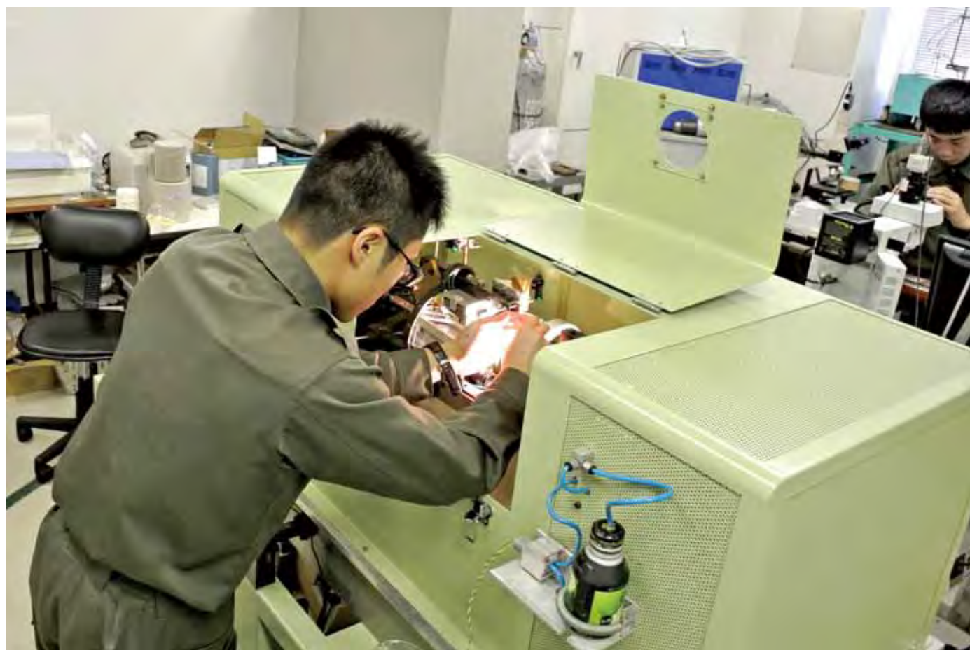
卒業研究（金属材料研究室）：遠心鑄造過程における結晶成長の様子を映像化し、その機構について研究します。
