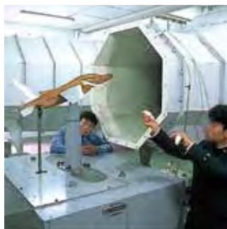
卒業研究（ヘリコプタ実験室）：ヘリコプタ・ロータの力学や流れの様子を飛行特性測定装置により理解する。
