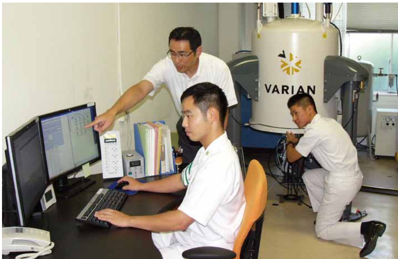
卒業研究：固体核磁気共鳴（固体 NMR）法を用いて、分子レベルで素材の組成や構造、運動性といった情報を取得します。
