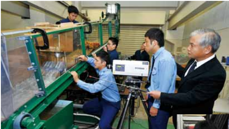
防災構造学：砂防構造物の実験
