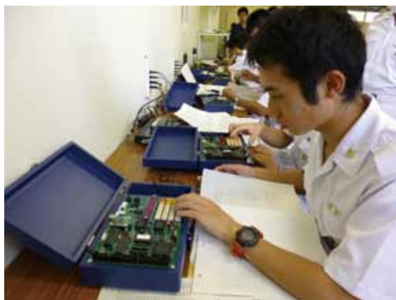
情報工学実験Ⅰ：再構成可能素子（CPLD）によるプログラミングとハードウェア（IO）の制御の実習。実験では学生への個別指導が行なわれる。
