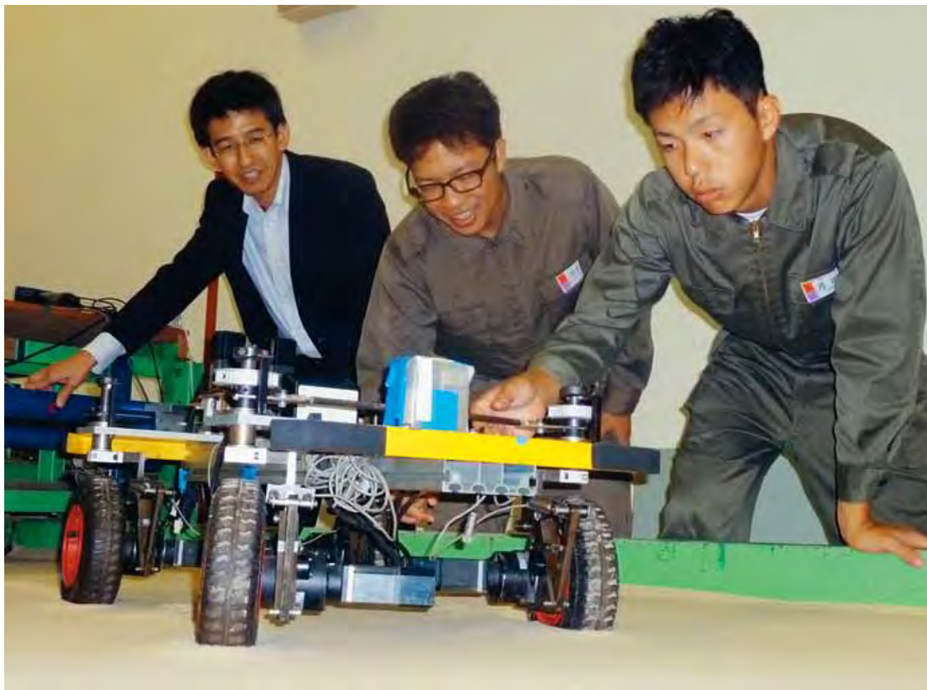
卒業研究（自動車実験室）：模型車両を使った実験により軟らかい地面での走行性を調べる。
