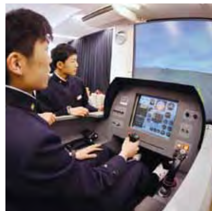
卒業研究（フライトシミュレータ実験室）：T-4 練習機のフライトシミュレータ。急激に旋回すれば機体が破損するシミュレーションもプログラムされている。
