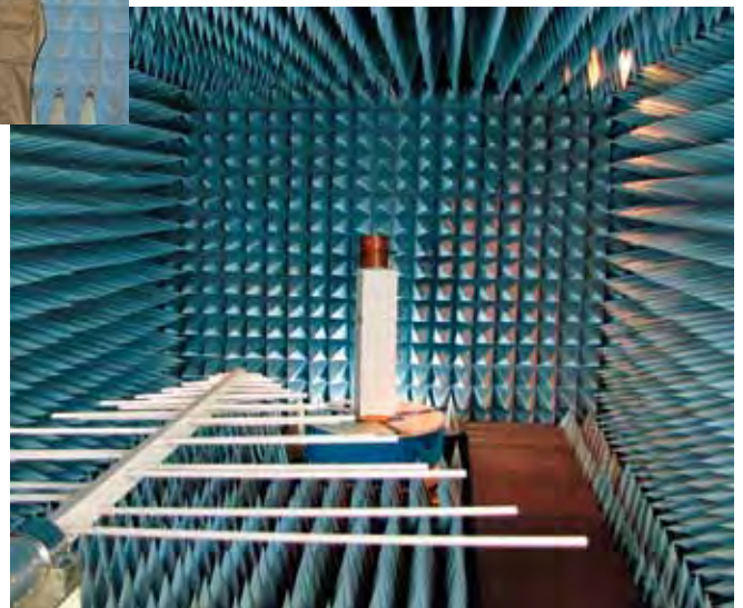
卒業研究（電気基礎学研究室）：ステルス性の評価基準となるレーダ断面積の簡易電波暗室を利用した高精度測定法の研究
