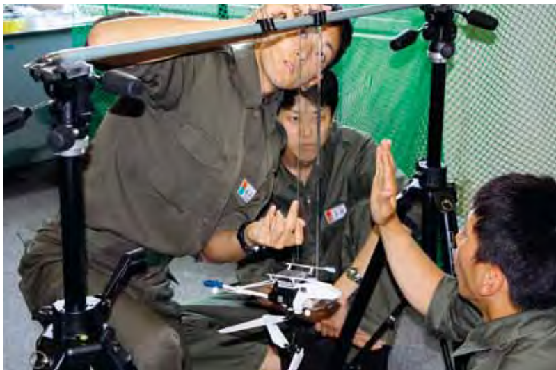
卒業研究（計測制御実験室）：RCヘリコプタの飛行制御実験のための模型諸元計測
