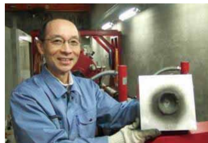
超高速衝突によってアルミニウム板に形成されたクレーター
