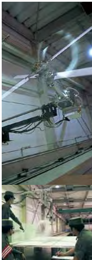
卒業研究（ヘリコプタ実験室）：ヘリコプタ・ロータの力学や流れの様子を飛行特性測定装置により理解する。
