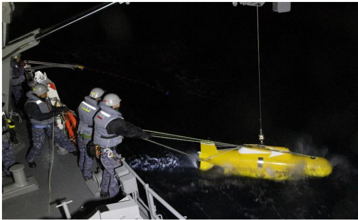
機雷処分具(PAP)投入(夜間)
