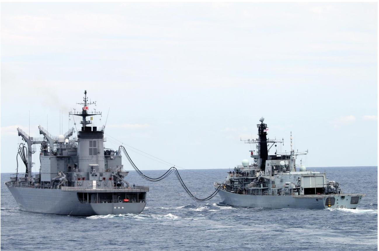
模擬洋上給油訓練を実施中の補給艦「ときわ」(左)と英フリゲート「サザーランド」(右)
