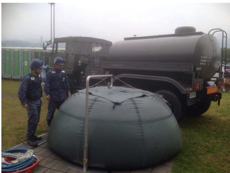
貯水タンクが満水になった状態
